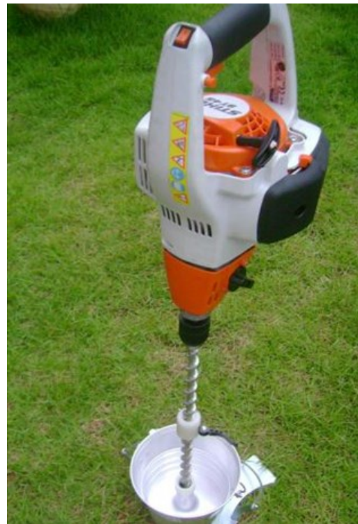
Figura 6: Amostrador manual com motor de combustão interna
