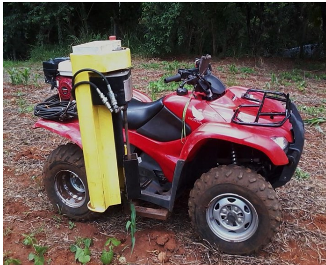
Figura 5: Amostrador hidráulico automatizado montado em quadriciclo
