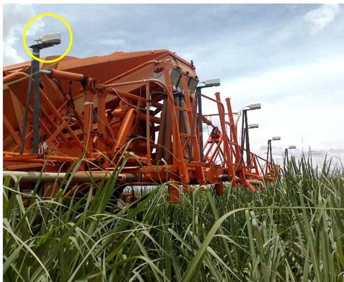
FIGURA 1. Sensores de dossel CropCircle ACS-210 acoplados na barra de aplicação do Uniport 3000 NPK (Máquinas Agrícolas Jacto).
