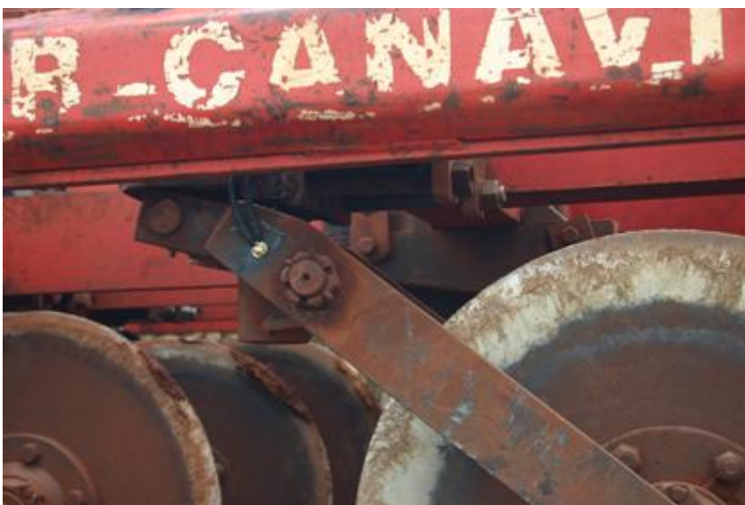
Figura 8: fixação do contato elétrico do disco com o cabo.
