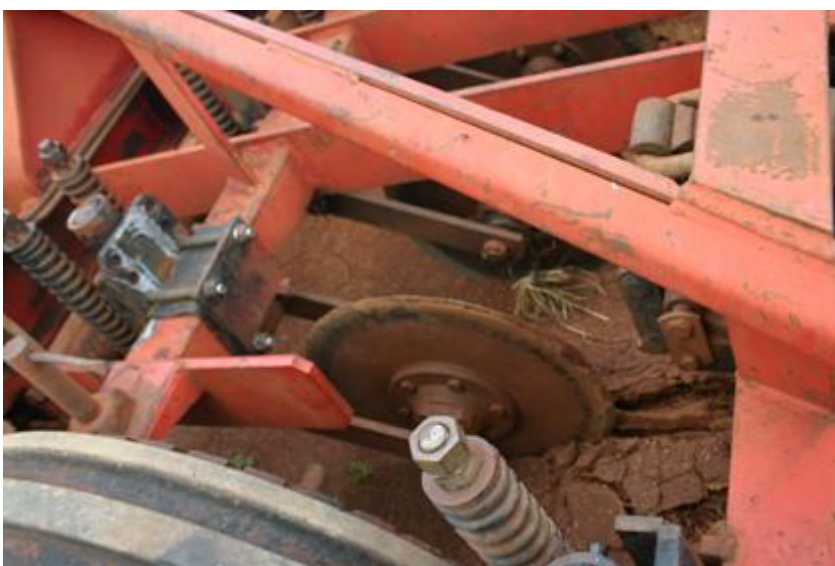
Figura 7: Isolação elétrica do disco de corte com manta de borracha
