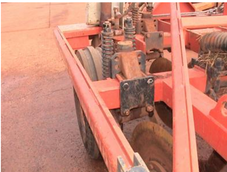
Figura 6: Fixação do disco a armadura do subsolador.
