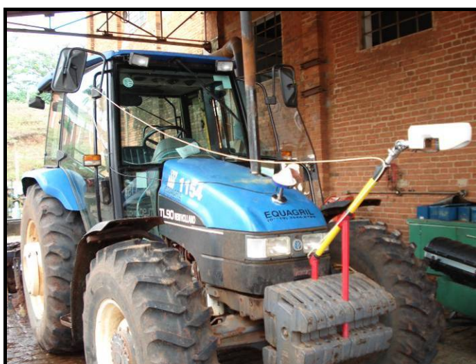
Figura 2 – Instalação do sensor ótico ativo na parte frontal do trator.
