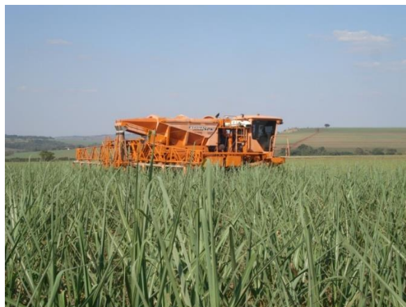
Figura 6. Aplicação de nitrogênio em cana a partir do uso de sensores ópticos ativos.
