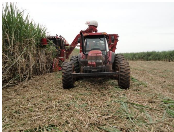
Figura 5. Colheita mecanizada de cana crua com tratores, transbordos e colhedoras com espaçamento entre rodas ajustado.
