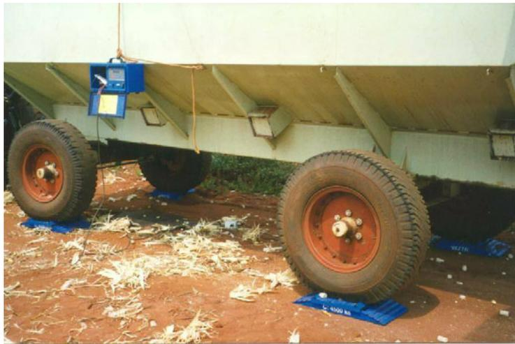
Uma maneira de se fazer a calibração no campo é pesar a quantidade colhida em cada descarga da colhedora e confrontar o resultado com aquele lido no monitor.
