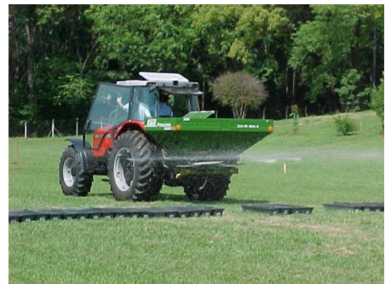
Figura 3. Aplicação de fertilizante a taxa variada por controlador.
