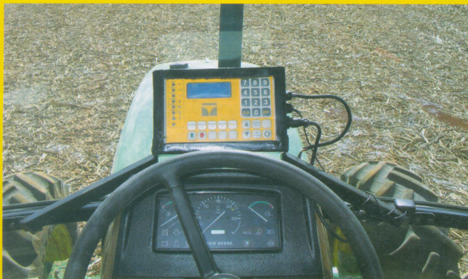
Monitor do controlador para taxa variada em operação, instalado na cabine de um trator
