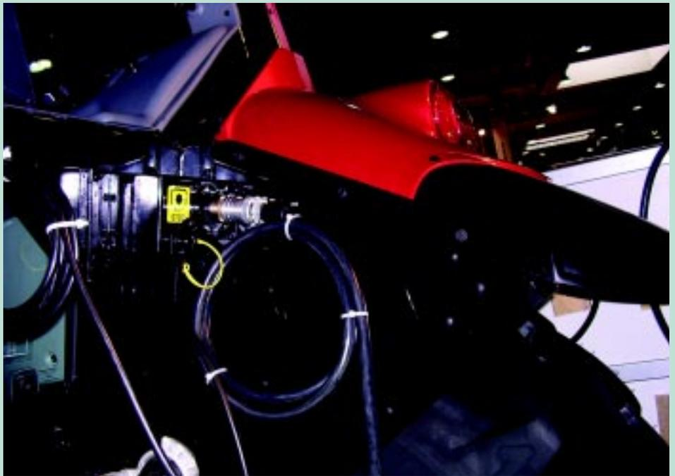
Conexão padrão para ligação eletrônica entre os barramentos da máquina e do trator
