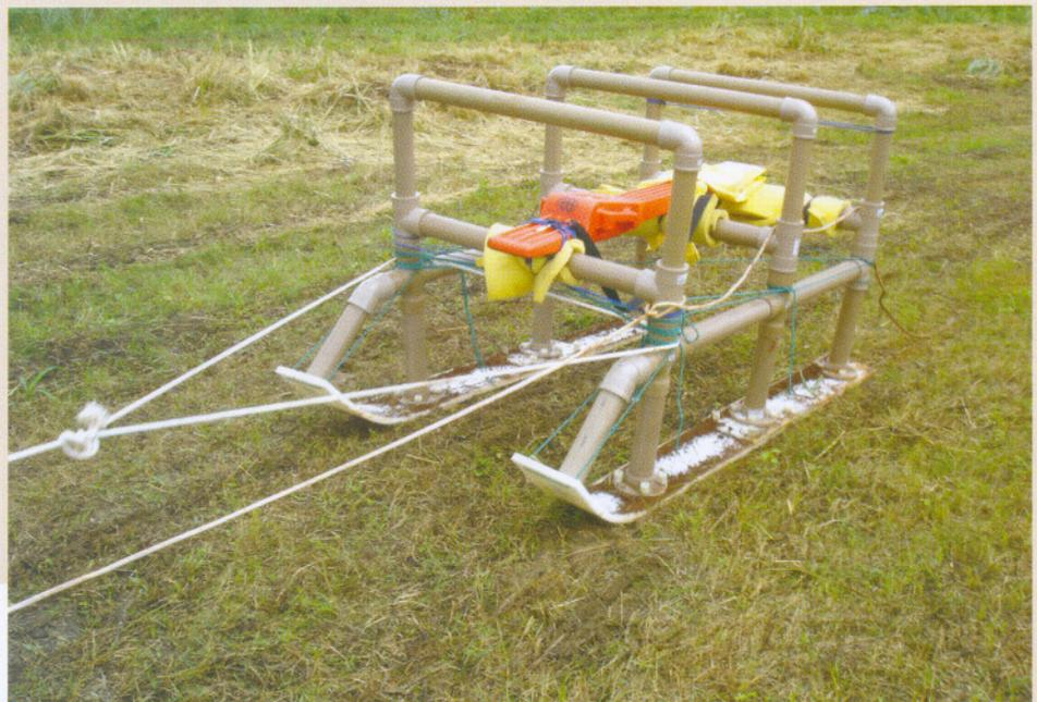
Protótipo de um dispositivo feito com tubos de PVC serve como veículo para o sensor de condutividade elétrica, testado na Esalq/USP
