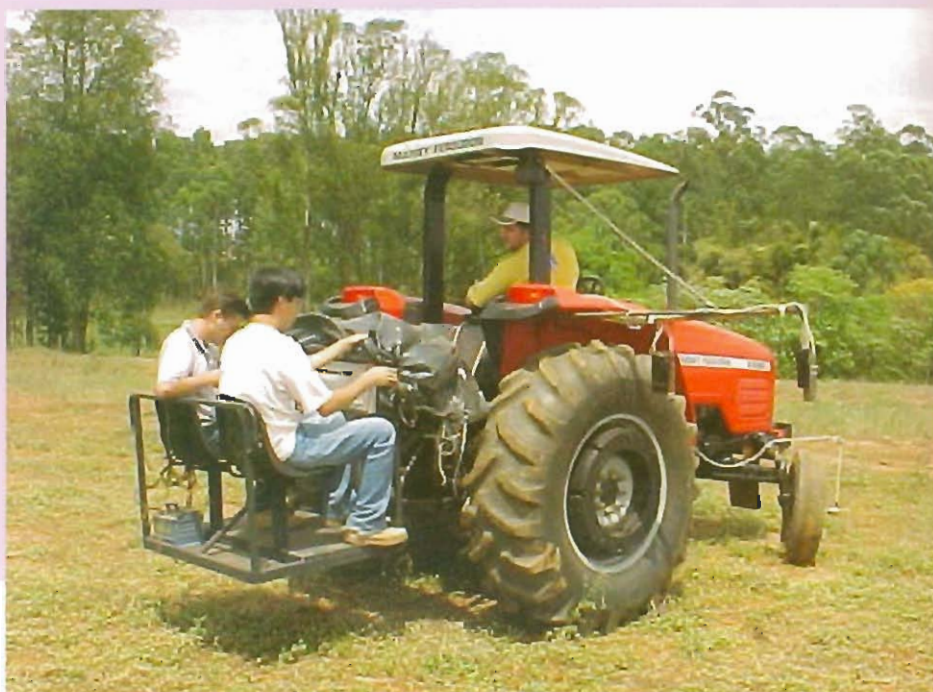
Figura 2 - Bancada de instrumentação acoplada ao sistema hidráulico de três pontos do trator
