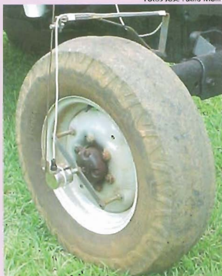
Figura 1d - sensor óptico com 240 pulsos por volta, marca Hohner, fixado na roda dianteira direita do trator
