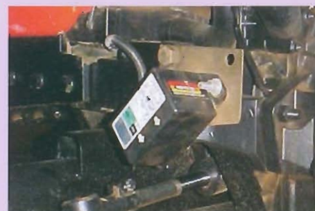
Figura 1b - Sensor de radar de velocidade modelo RGSS-201, da marca Mid-Tech
