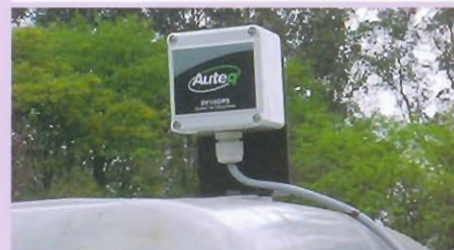
Figura 1c - Receptor de GPS como sensor de velocidade, modelo SV18GPS, da Auteq
