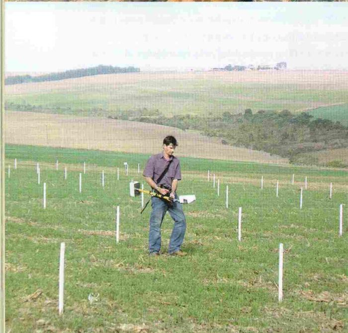
Para a mecanização da coleta do solo, existem os Amostradores de Solo, que são equipamentos para automatizar este processo, já que é feito em grandes quantidades. Devido a essa necessidade de obtenção de grande número de amostras e dados com menos custo, desenvolveu-se a proposta de uma série de ideias de sensores para monitorar o solo. É o caso dos diferentes modelos de sensores de condutividade elétrica.
