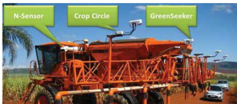
Figura 5. N-Sensor ALS (Yara International ASA, Duemen, Alemanha), Crop Circle ACS-210 (Holland Scientific, Lincoln, NE, EUA) e o GreenSeeker (Trimble Navigation, Ltd., Sunnyvale, CA, EUA), acoplados em um Uniport 3000 NPK (Máquinas Agrícolas Jacto AS, Pompéia, SP, Brasil).
