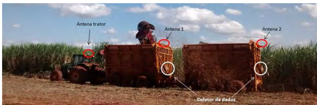
FIGURA 1. Representação da disposição das antenas de GNSS no conjunto.
