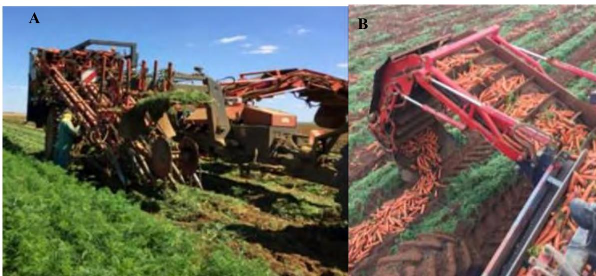
FIGURA 1. Sistema de colheita da cenoura semi-mecanizada. Colhedora de cenoura (A). Enleiramento das raízes ao lado da colhedora (B).
