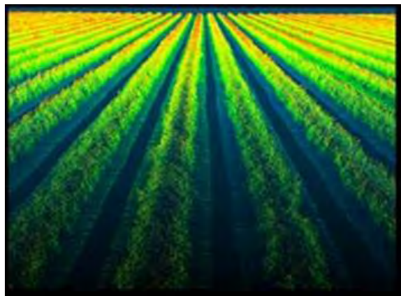
FIGURA 1. Nuvem de pontos obtida com sensor LiDAR para a cultura da laranja (MOLIN, AMARAL e COLAÇO, 2015)
