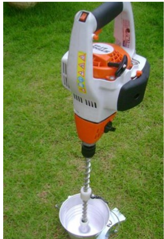
Figura 6: Amostrador manual com motor de combustão interna
