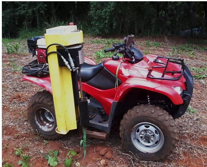
Figura 5: Amostrador hidráulico automatizado montado em quadriciclo
